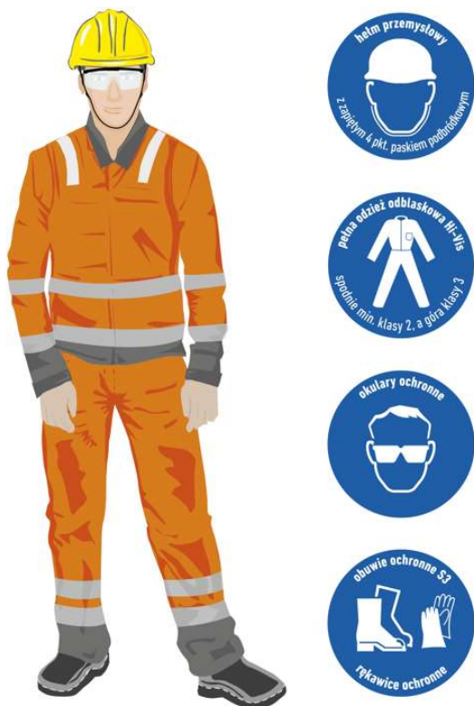
Rysunek nr 7 / Minimalne wymagania dot. odzieży, obuwia oraz ŚOI wobec Odbiorców i Dostawców
