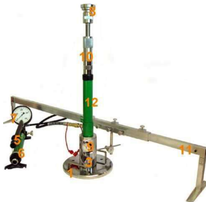
Rys. 1.2. Aparatura VSS jednopunktowy pomiar przemieszczenia płyty
