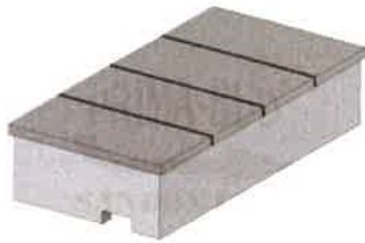
Rys. 13. Przykład zasobnika żelbetowego
