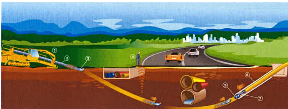
Rys. 30. Wykonywanie otworów pod kanalizację kablową metodą przewiertu
