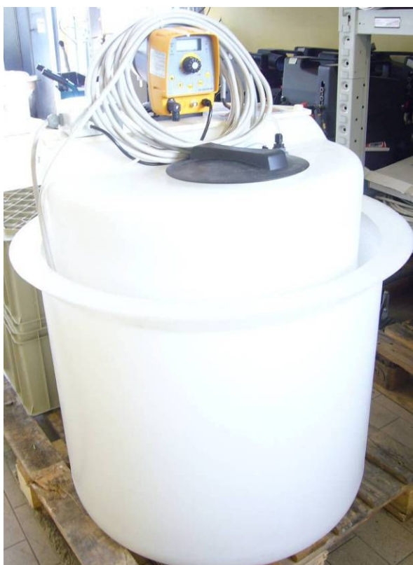
Rysunek 7 Zbiornik na substancje chemiczne ze skrzynką bezpieczeństwa i pompą dozującą
