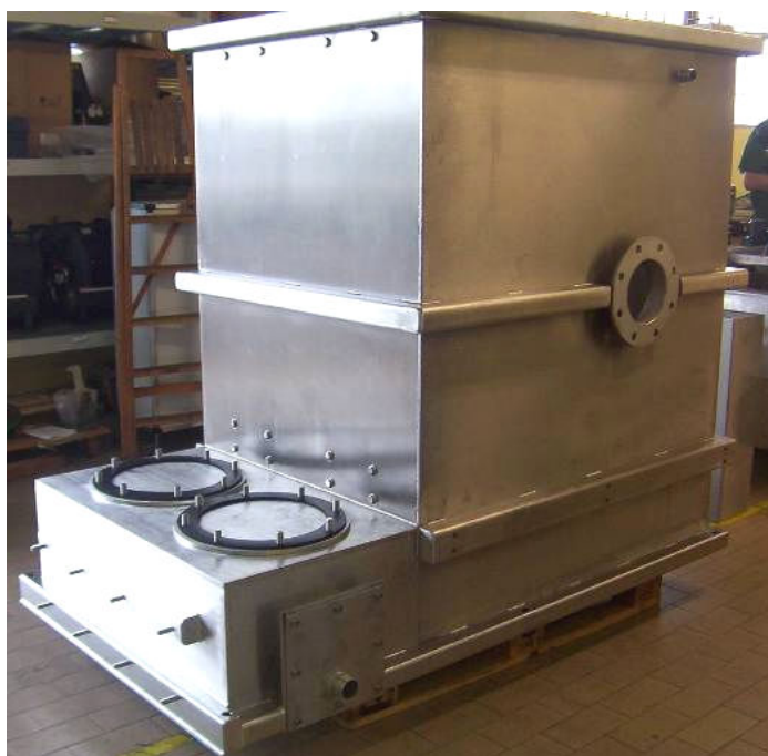
Rysunek 3 Zbiornik rozdrabniacza (bez rozdrabniaczy i pomp)
